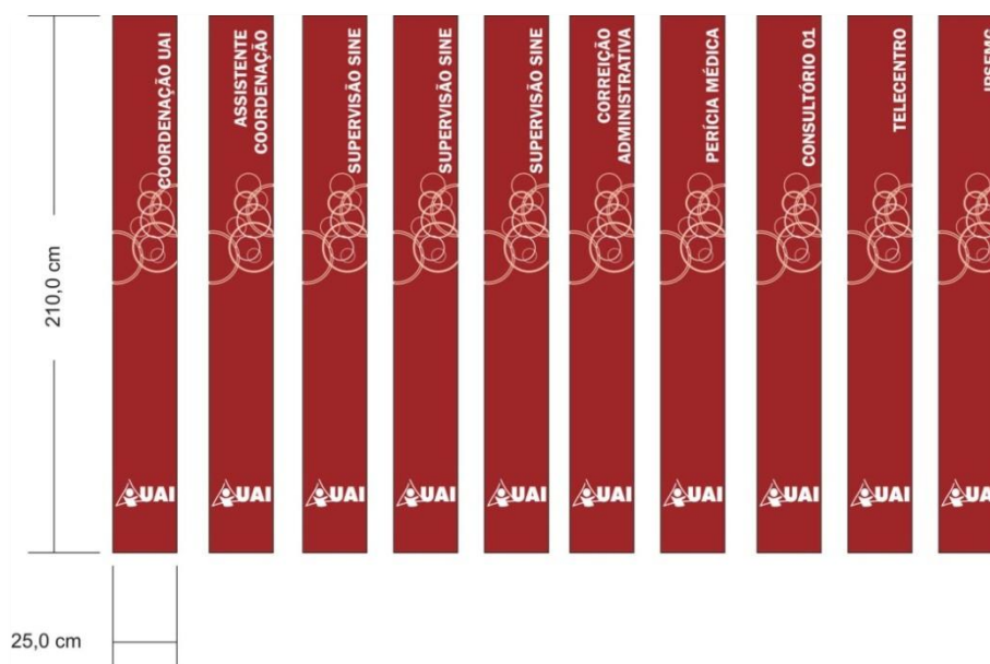
Figura 18 - Placa para fixação em divisória ou alvenaria
